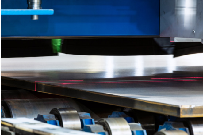
Bild 2: Das System projiziert Laserlinien auf das Blech
