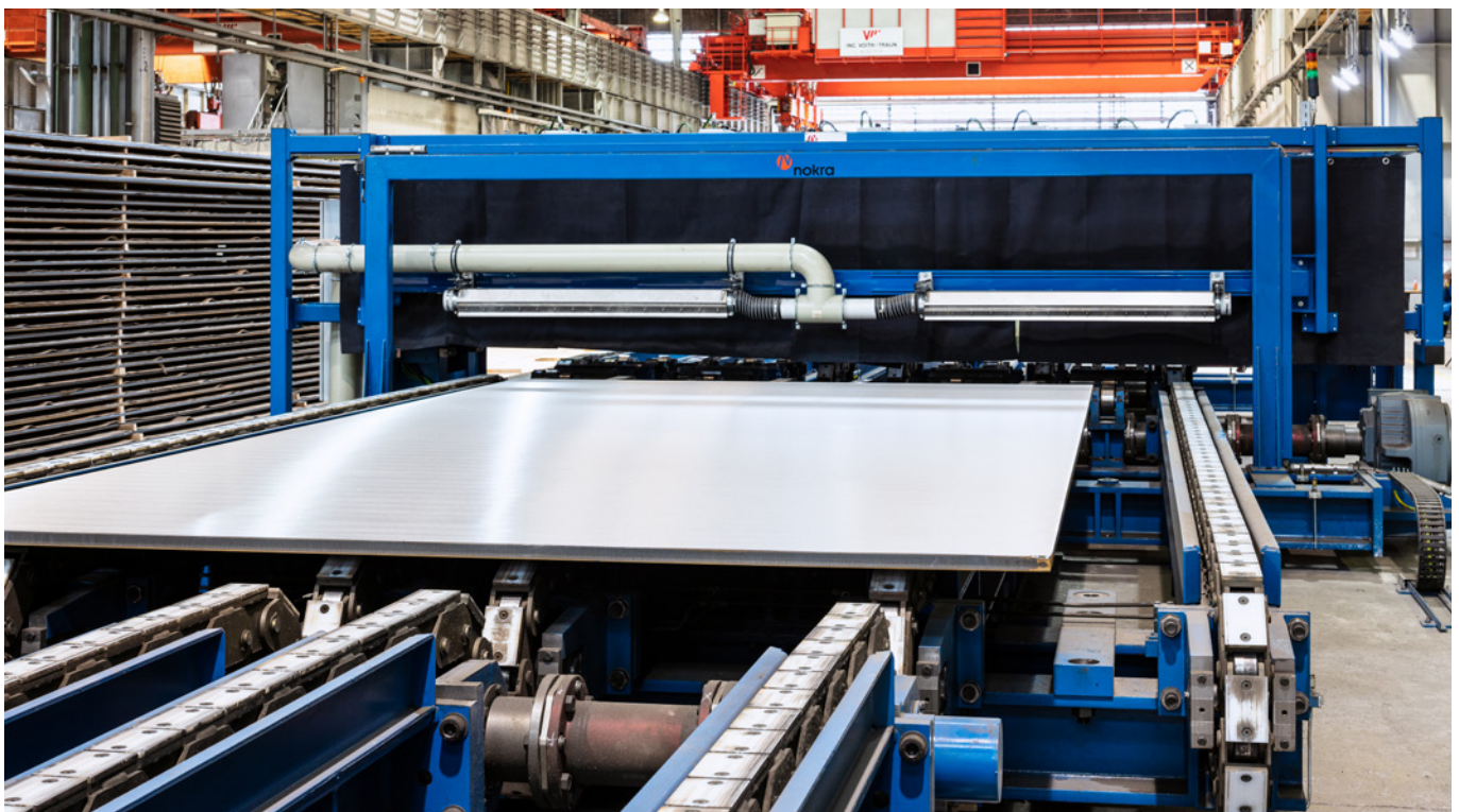
Bild 1: Ein walzplattiertes Blech läuft in die Messanlage ein (Quelle: voestalpine)
