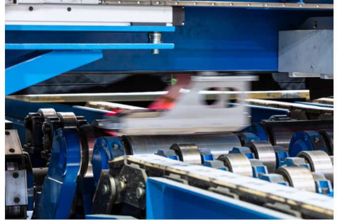
Bild 3: Der Justierkörper fährt über die gesamte Breite des Blechs
