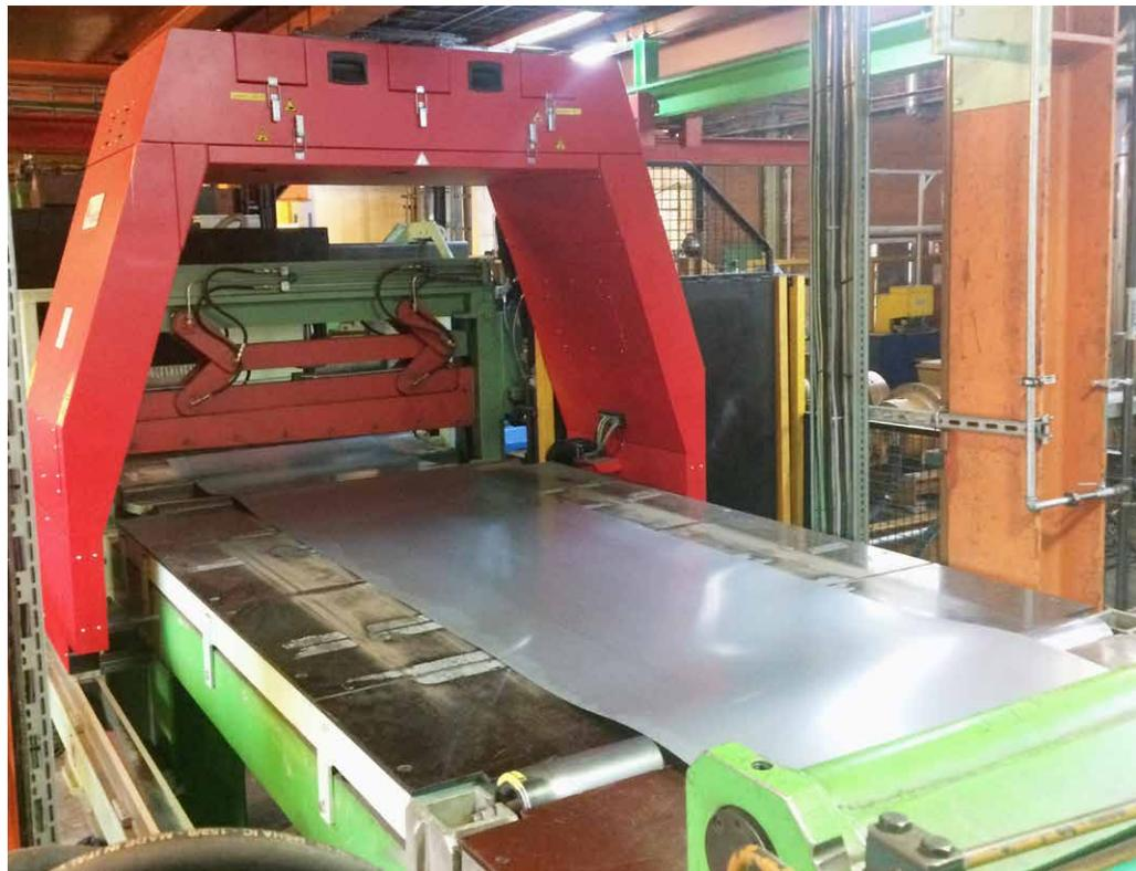
**Die Lichtschnittsensoren alpha.VR von nokra sind in einem Portal über dem Messgut integriert** (Foto: thyssenkrupp Steel)
