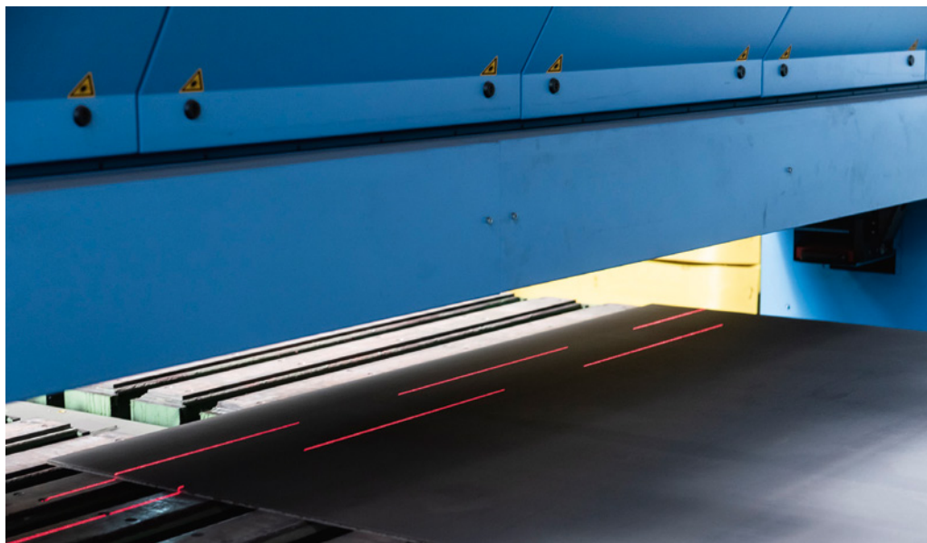
Die Laserlinien der einzelnen Sensoren sind versetzt, damit die Signale der Kameras eindeutig unterschieden werden können (Bild: thyssenkrupp Steel Europe)
