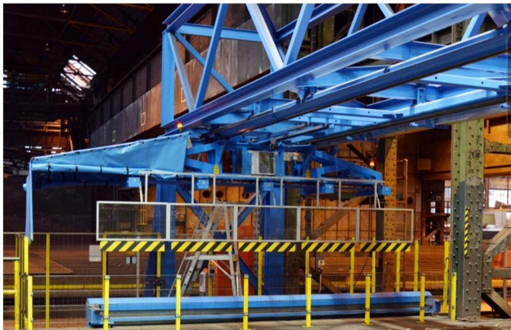
**Bild 7.** Der Messbalken mit seinen fünf Sensoren in der Parkposition; der Hartstein-Justierkörper ist darunter installiert (Foto: Salzgitter Mannesmann Grobblech)
