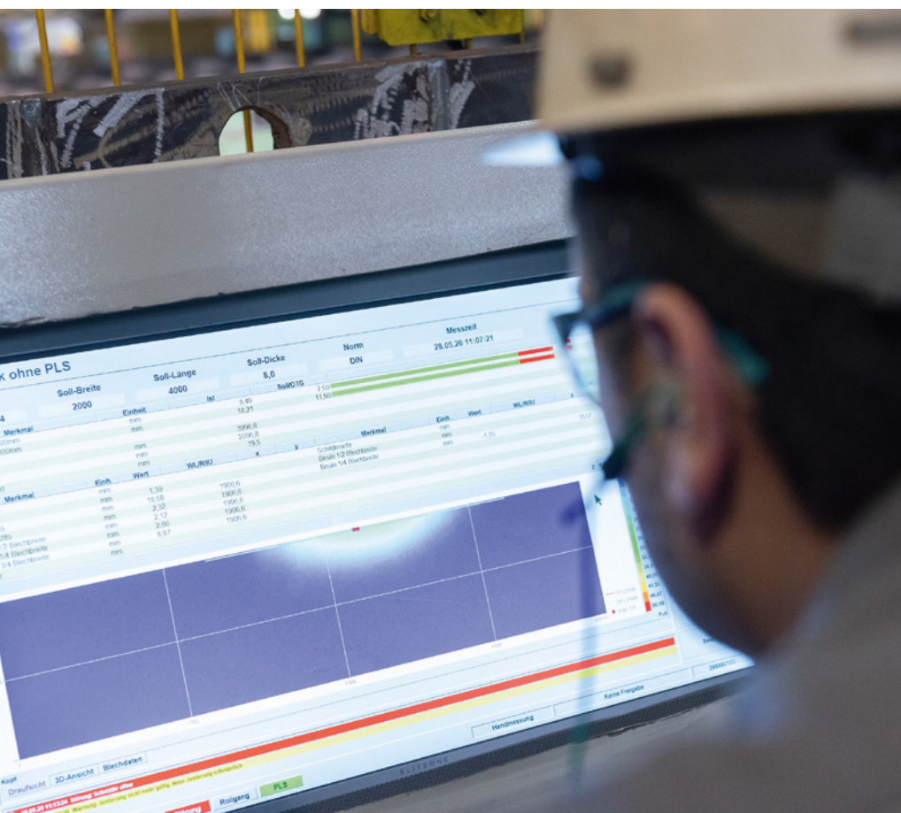
Die Blechtopographie wird in einer Falschfarbendarstellung als räumliche 3D-Ansicht oder als Draufsicht visualisiert (Bild: thyssenkrupp Steel Europe)
