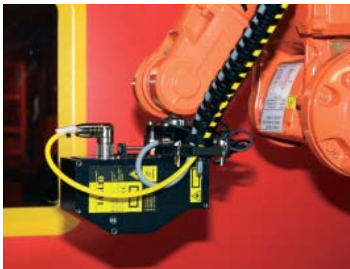
Bild 2. Laser-Lichtschnittsensor an einem Knickarmroboter zur Vermessung von Schweißbaugruppen
