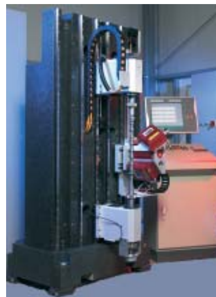
Bild 2. Die Nockenwellenprüfmaschine mit Lasersensoren vermisst die Formen und Positionen der Nocken
