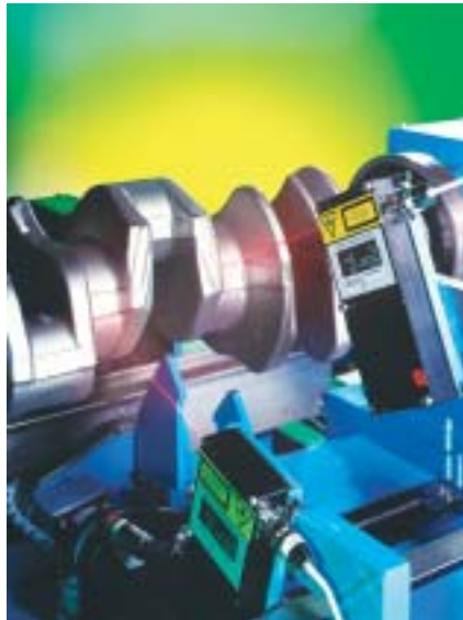
Bild 1. Prüfmaschine für Kurbelwellen: Die Laserstrahlen der Lasertriangulationssensoren sind auf Lager der Kurbelwelle gerichtet
