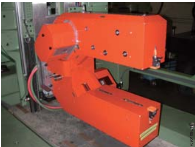
C-Rahmen mit Lasertriangulationssensoren für die Prüfung von Großrohren (Foto: NOKRA)
