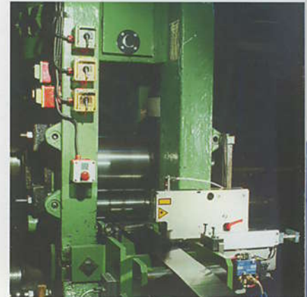
▼ Kaltwalzwerk mit Laserdickenmesseinrichtung
