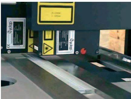
ABBILDUNG 5: Detailansicht einer Prüfmaschine für Wellrippen. Das Messobjekt wird von zwei Lasersensoren abgetastet. (Quelle: NoKra)
