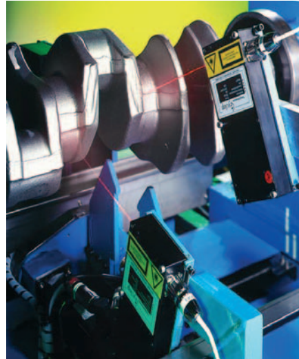
ABBILDUNG 4: In dieser Detailsicht einer Prüfmaschine für Kurbelwellen sind zwei Lasersensoren zu erkennen, deren Laserstrahlen auf Lager der Kurbelwelle gerichtet sind. (Quelle: NoKra)
