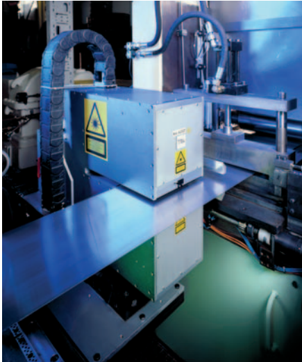
ABBILDUNG 3: Ansicht eines Laserdickenmessgeräts für die Online Messung der Dicke von Metallbändern unmittelbar im Anschluss an ein Walzgerüst (rechts hinten). (Quelle: NoKra)
