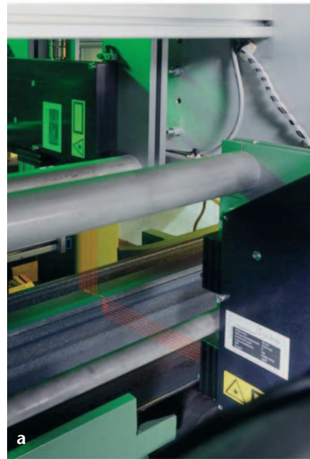
ABBILDUNG 3: (a) Bei der Geradheitsmessanlage ist jeweils ein Messsensor seitlich neben der Schiene und der andere über der Schiene angebracht. (b) Mit dem Triangulationsverfahren wird die Abweichung s von der Geradheit der Schiene bestimmt. (c) Insgesamt 14 Messsensoren bilden das Messlineal. Bei einer Messfrequenz von 30 Hz beträgt die Messbereichsauflösung 2 \mu\text{m} . (Quelle: TSTG)
