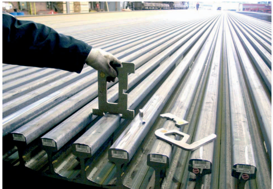
ABBILDUNG 1: Früher musste jede einzelne Schiene mit zertifizierten Schablonen aufwändig vermessen werden. Heutzutage übernehmen direkt in die Produktionslinie eingebaute Lasermessanlagen diese Aufgabe. (Quelle: TSTG)
