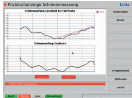
ABBILDUNG 6: Bei der Anlage zur Endengeradheitsmessung kann mit einer Messfahrt sowohl die Geradheit der Fahrfläche, als auch die der Seite ermittelt werden (links). Die Messdaten werden im Rechnersystem mit den Vorgaben gemäß Liefernormen verglichen und sind innerhalb von Sekundenbruchteilen in einem Auswertprogramm auf dem Bedienerbildschirm zu sehen (rechts). (Quelle: TSTG)
