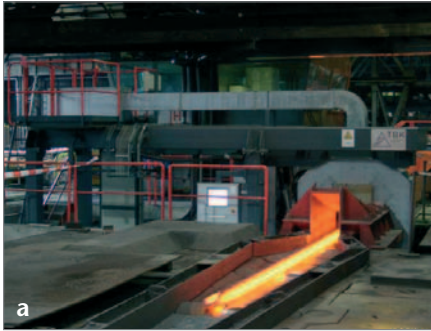
ABBILDUNG 2: (a) Die Lasermessanlage zur Warmprofilvermessung ist im Auslauf hinter der Walzstraße installiert. (b) Ein Auswertungsprogramm rechnet die bei rund 950–1000 °C gemessenen Maße auf ein Kaltmaß um. Früher musste man von heißen Schienen eine Probe absägen, erkalten lassen und mittels Schablonen vermessen. (Quelle: TSTG)
