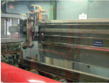
ABBILDUNG 6: Bei der Anlage zur Endengeradheitsmessung kann mit einer Messfahrt sowohl die Geradheit der Fahrfläche, als auch die der Seite ermittelt werden (links). Die Messdaten werden im Rechnersystem mit den Vorgaben gemäß Liefernormen verglichen und sind innerhalb von Sekundenbruchteilen in einem Auswertprogramm auf dem Bedienerbildschirm zu sehen (rechts). (Quelle: TSTG)
