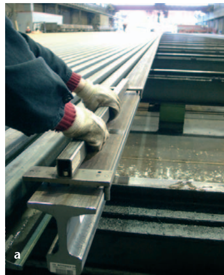
ABBILDUNG 5: (a) Der Aufwand bei der manuellen Verdrillungsmessung ist enorm: Beispielsweise muss die Schiene zu diesem Zweck mittels hydraulischer Kantgeräte gedreht werden. (b) Bei der Lasermessung dagegen werden die Enden der Schienen direkt in der Produktionslinie beim Überfahren der Messanlage abgetastet. Die dafür notwendigen vier Lasermessensoren befinden sich in den roten Gehäusen in der Bildmitte. (Quelle: TSTG)
