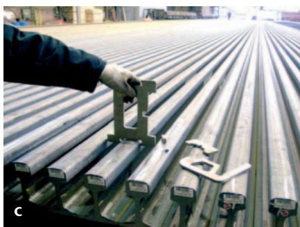
ABBILDUNG 4: Zehn Laserlichtschnittsensoren erfassen bei der Kaltprofilvermessung die Maßhaltigkeit von Höhe, Fußbreite, Stegdicke etc.: (a) die reale Messung, (b) das Prinzip. (c) Zum manuellen Messen wurden früher Schablonen verwendet, die regelmäßig geprüft und zertifiziert werden mussten. (Quelle: TSTG)
