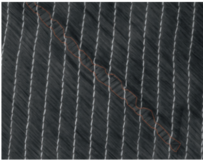
Bild 3. Das System erkennt Gaps in der Struktur
