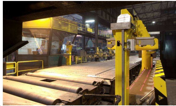
(Рис.3 Измерительный портал в позиции юстировки)
