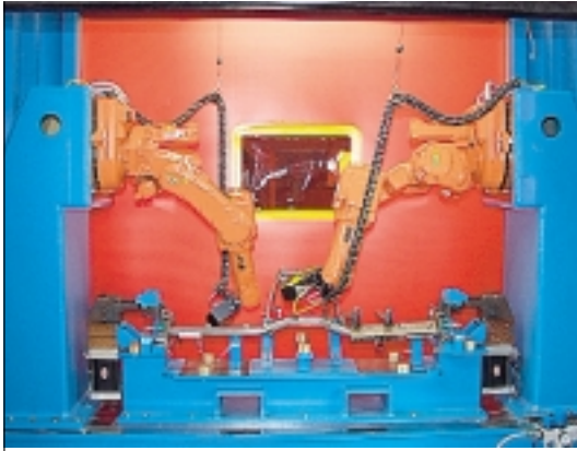
Laser-Messanlage für Automobil-Querträger.
