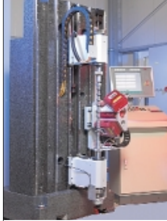
Wirtschaftlich und hochgenaue Messmaschine für Rotationsteile in vertikaler Ausführung.
